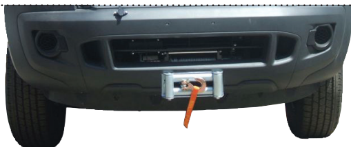
MONTAGGIO CON VERRICELLO A CAVO
